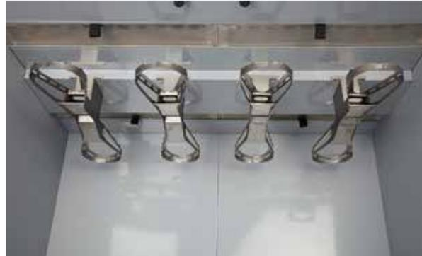
Beste Trocknungsergebnisse mit vier stabilen Kleiderstangen, für einen effizienten Luftstrom durch die Anzüge. Bei diesen Spezialaufhängern wird zuerst Heißluft durch die Innenseiten der Anzüge geblasen und dann außen um die Anzüge herum. In der Decke des Trockenschanks sitzen vier Flusenfilter.
